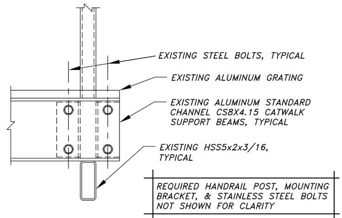
**3 CATWALK BEAM END CONNECTION**
